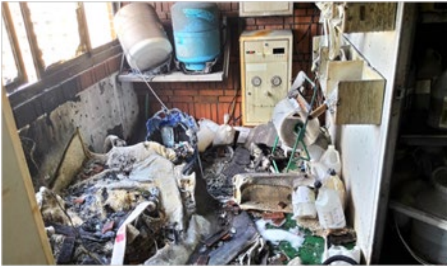
消防隊處理後照片，左下角為熔毀之抽風櫥及清洗台，右側為化學廢液及化學品空桶等固態廢棄物暫存區。
